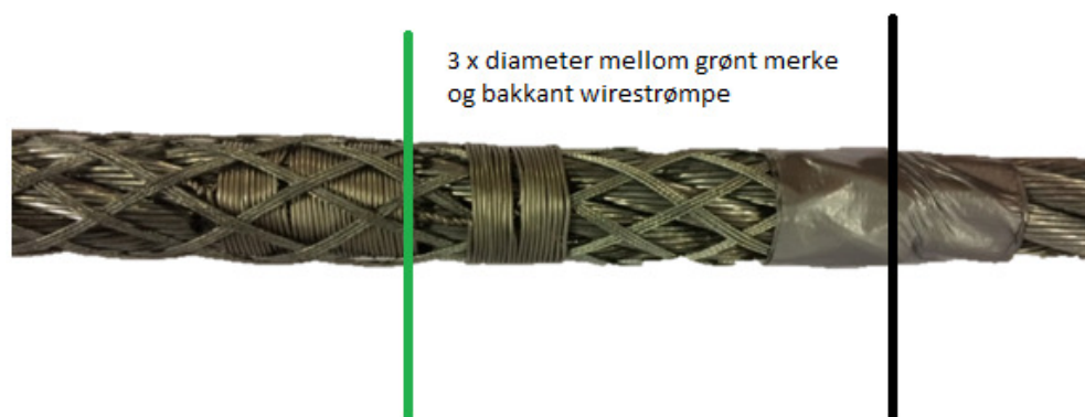
Figur over. Viser ferdig montert strømpe, bendslet mothold på ståltau, bendslet bakkant av wirestrømpe over mothold, og avsluttende tape for å gi en glidende overgang mellom wirestrømpe og ståltau/kabel.
