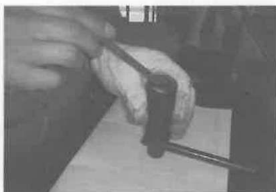
① Fyll skruen med smøremiddel innvendig.
